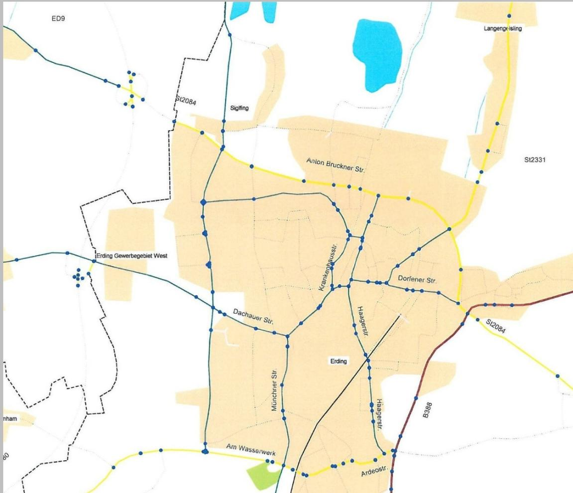
Unterteilung des Untersuchungsnetzes in ca. 450 Streckenabschnitte (Länge von 160 km) zur Abbildung der gegebenen Infrastruktureigenschaften
